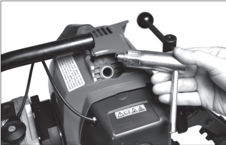
FIG. 29 – LIMPIEZA DE LA BUJÍA DE ENCENDIDO
